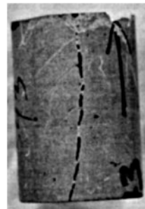
Figura 4. Núcleo de carbonato donde se muestra una fractura vugular, cortesía de B.J. Ward, Jr. (Nelson, 2001, p.60).
